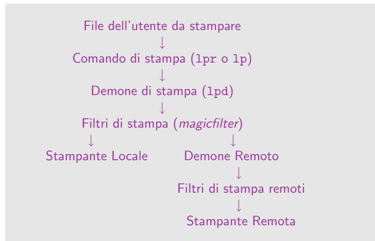
Figure 10.1 Il meccanismo di stampa sotto UNIX
